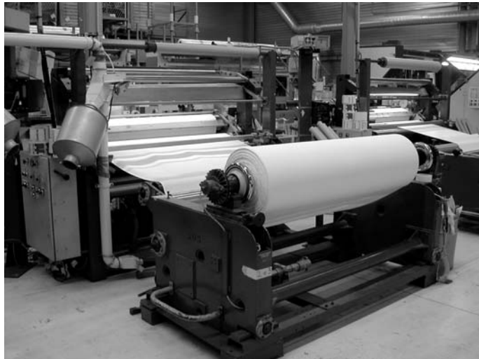
Illustration 1: Machine d'inspection de tissu - Vue d'ensemble
